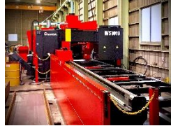
大型H形鋼穴あけ切断複合ライン AMADA WS-1000 （玉村北工場）
