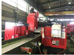
大型H形鋼加工ライン【2台】 AMADA 6BH-1000Ⅲ （本社加工工場・栃木第一工場）
