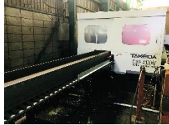
形鋼複合加工機【3ライン】 TAKEDA CBF-4020W （本社第4工場） TAKEDA CBF-250W AMADA 3BC-300 （本社第2工場）
