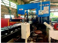
コラム切断用バンドソー DAITO GTA II 5580CNC （本社加工工場） AMADA HKB6050CNC （栃木第二工場）
