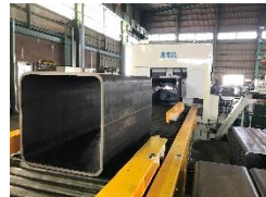
コラム切断開先ライン【2ライン】 SHINX VZ-800C DAITO KCR-600 （本社加工工場） □150～□800対応可能
