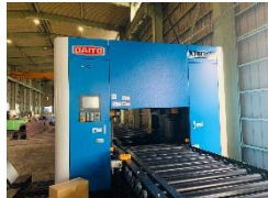
H形鋼用開先加工機 （両端開先対応機） DAITO KHR1050 （玉村北工場）
