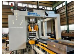
H形鋼用開先加工機【4台】 SHINX MHV-1050NCA （本社加工工場・第2工場） SHINX MH-40N（本社第3工場） SHINX MHV-1050A（栃木第一工場）
