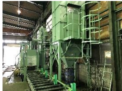
形鋼用ショットブラスト NICCHU AF-376 （本社加工工場） SHINTO KAC-2IS （栃木第一工場）
