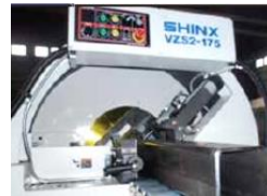
角パイプ開先加工機 SHINX VZ2-175 （本社加工工場） □100～□175対応可能
